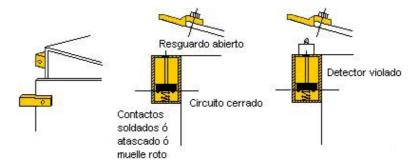
Es facilmente violable: basta mantener presionado el vástago con cualquier artilugio (pesas, cinta adhesiva, cuñas, etc.). En caso de rotura del muelle, atasco o contactos soldados mantiene el circuito cerrado aún con el resguardo abierto,
