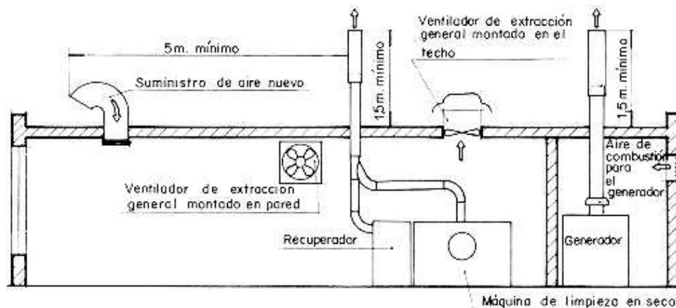
El aire extraído del local, así como la salida de los equipos de adsorción por carbón activo, no se debe recircular en la planta para evitar la acumulación de disolventes. Las chimeneas deben tener una altura mínima de 1,5 m. por encima de la cubierta más alta o estructura adyacente, y estar situadas por lo menos a 6 m. de cualquier entrada de aire para evitar el retorno del aire extraído dentro de la planta.
