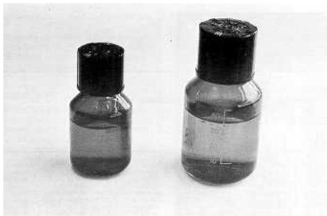
**Fig. 5: Frascos para el transporte de muestras y soluciones absorbentes**
