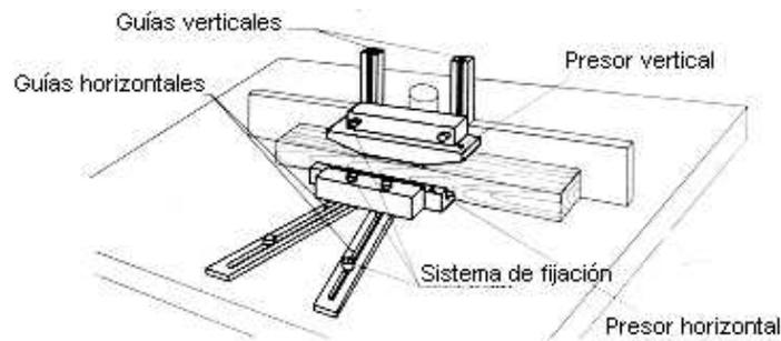
**Fig. 11: Sistema protector-presor de guías**
