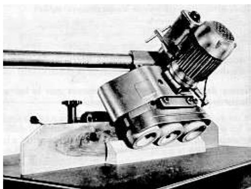
**Fig. 7: Carro de alimentación operando (Fuente: Catálogo comercial del carro de avance MATO)**
