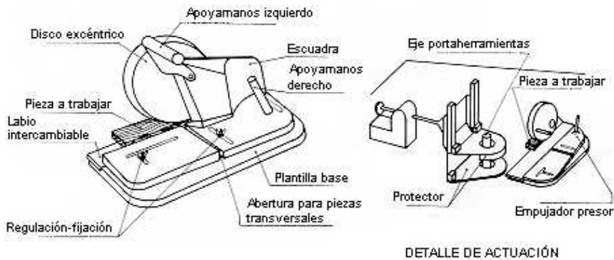
**Fig. 23: Empujador de disco excéntrico**
