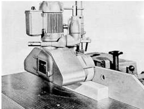
**Fig. 9: Carro de alimentación operando (Fuente: Catálogo comercial del carro de avance MATO)**
