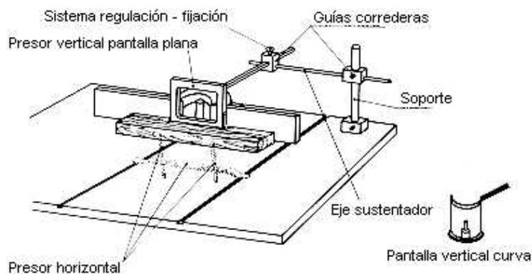
**Fig. 12: Sistema protector-presor de pantalla transparente**
