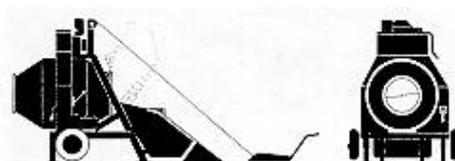
**Fig. 2: Hormiguera semi-fija**
