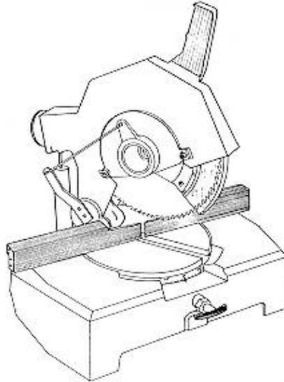
**Fig. 3: Pantalla retráctil de protección del disco**
