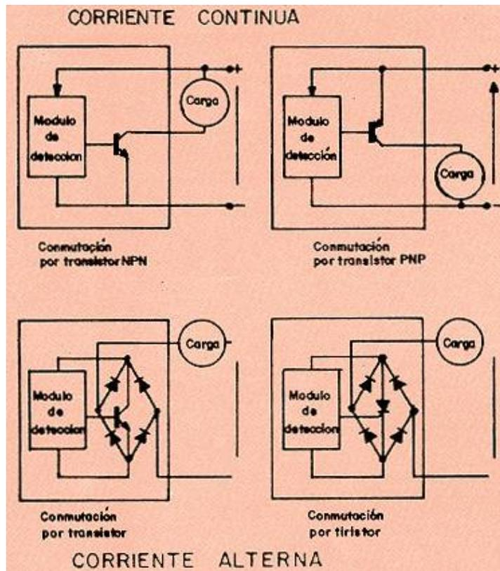
Dando lugar a los modelos de dos y tres bornes de salida, estos últimos a extracción o inyección de corriente.
