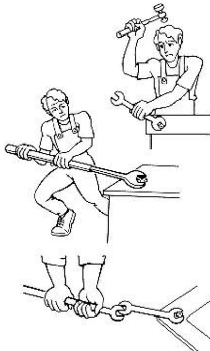
**Fig. 8: Utilización de llaves inadecuadas**
