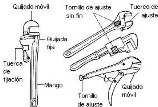
**Fig. 4: Llaves de boca ajustable y sus partes**
