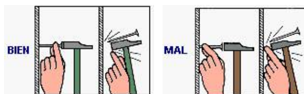
Fig. 8: Forma de sujetar un clavo antes de clavarlo
