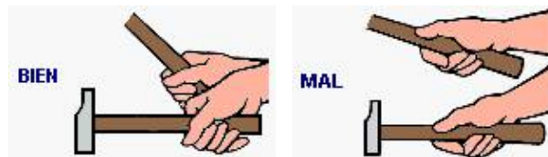
Fig. 6: Forma de sujeción del mango
