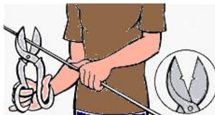
Fig. 15 Utilización incorrecta de tijeras con hojas melladas
