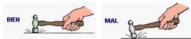
Fig. 7: Forma de golpear sobre una superficie
