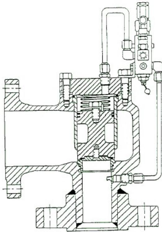
**Figura 5. Válvula de seguridad asistida por piloto**
