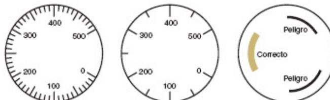
Además, el dispositivo debe proporcionar al usuario, siempre que sea posible, la información en las unidades adecuadas de forma que no sea necesario hacer conversiones posteriores. Por ejemplo, en la figura 11 se muestra un mismo dispositivo con diferentes unidades de escala: en la situación de la derecha se muestra la velocidad en valor absoluto, mientras que en la izquierda la velocidad se muestra como porcentaje del valor máximo. En esta situación es preferible la escala porcentual porque:
