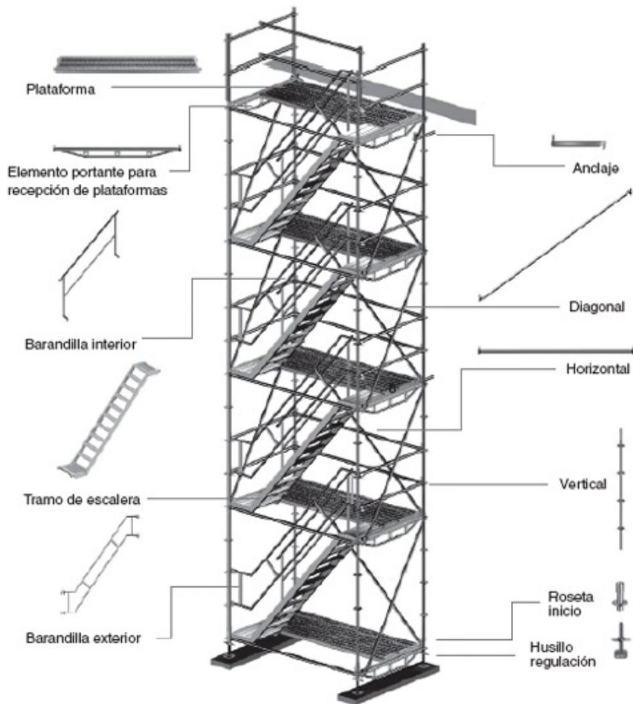
Nota: En caso de utilización de sistema modular los elementos verticales y portante se sustituirían por un elemento de marco.
